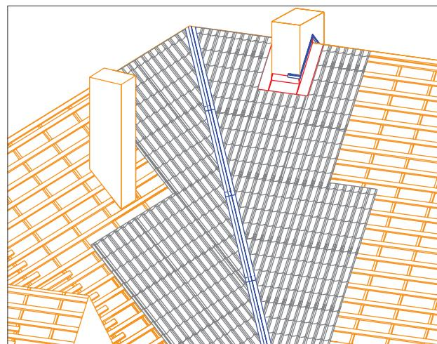
и течет по линии сгиба ендовы. Прошлогодние листья, попавшие на кровлю, также попадают под накладку ендовы и при достаточном зазоре между резанными краями металличерепицы будут смыты водой вдоль планок ендовы.
